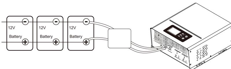
Шаг 5: Убедитесь в правильности подключения полярностей всех проводов и батарей, а также полярности проводов и клемм устройства.
